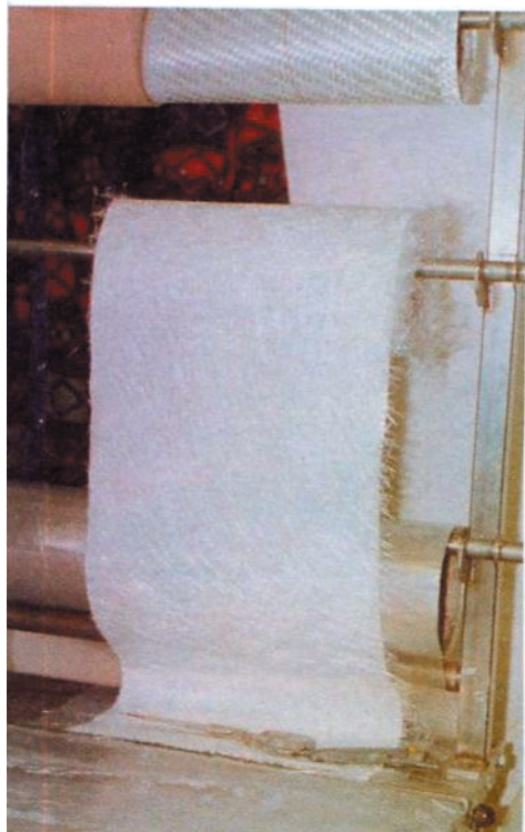
Le tissé de verre qui sert à la réhabilitation des canalisations est conditionné en rouleaux. Une fois la pièce désirée découpée, elle est enduite d'un mélange résine et durcisseur.
